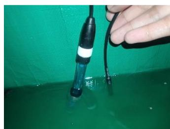
Gambar 19. Pegujian sensor suhu dan pH
