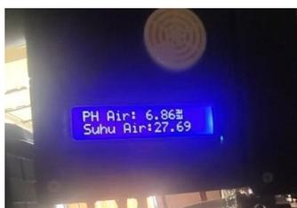
Gambar 26. Pengujian sensor pH dan suhu
