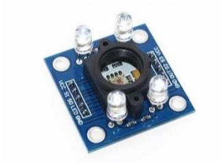
Gambar 3. Sensor warna TCS3200
