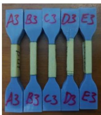
Gambar 8. Spesimen uji tarik.
