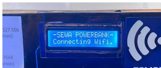
Gambar 12. Pengujian LCD I2C
