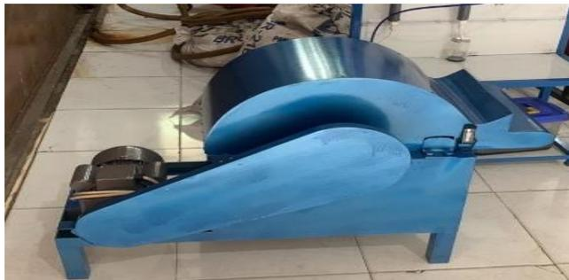
Gambar 1. Alat Dekortikator
