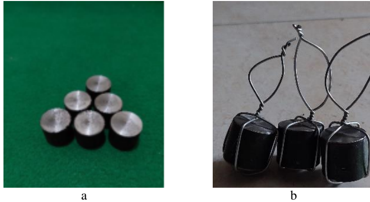
Gambar 2. a. Spesimen uji kekerasan b. Spesimen diikat untuk proses heat treatment
