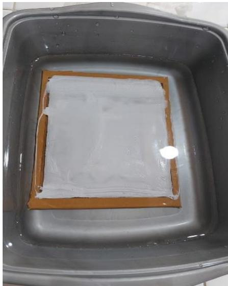
Gambar 1. Membran Polisulfon Ultrafiltrasi
