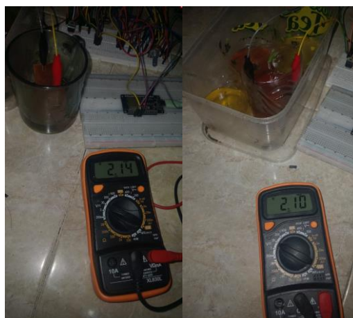
Gambar 15. Hasil Pengujian Rangkaian Amplifier Non-Inverting
