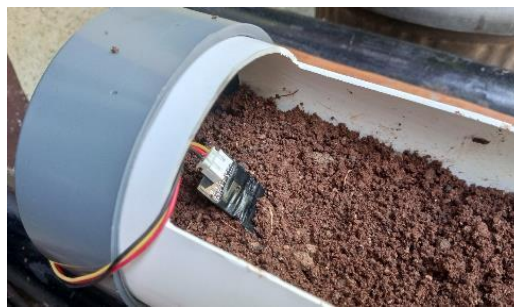
Gambar 21. Pengujian Sensor Soil Moisture
