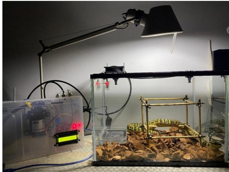
Gambar 8. Implementasi sistem kontrol kelembapan otomatis di terrarium Tropidolaemus sp.
