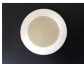
Gambar 4. Sampel Zeolit Menjadi Katalis untuk Uji Kadar Si/Al
