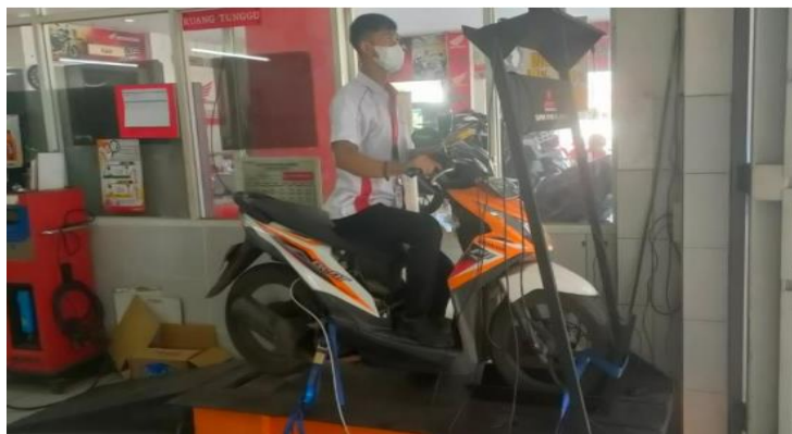
Gambar 2. Kondisi Pengujian Sepeda Motor di Chasis Dynamometer.
